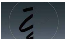
油性笔涂层效果测试比较 左: 无防污涂层 右: 有防污涂层
